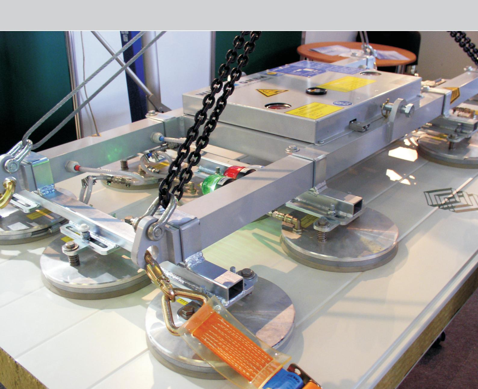
Работа установочных систем OKTOPUS основана на принципе "всасывания" и поднятия груза.
